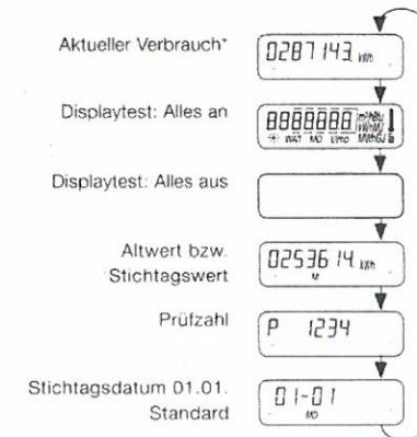
LCD-Anzeige eines Wärmezählers (am Beispiel G20, Displayebene 0)
