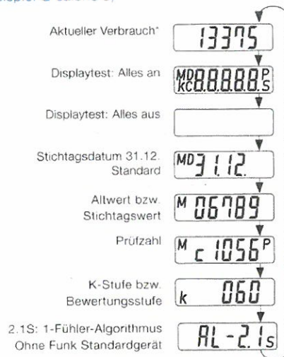
LCD-Anzeige eines Heizkostenverteilers (am Beispiel Q caloric 5)
